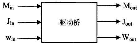
图 2.7 驱动桥模型的输入输出
