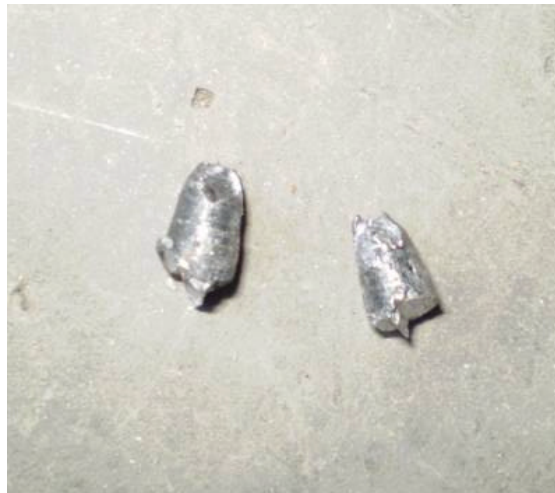
图 6.4 过早被切断的轧件
