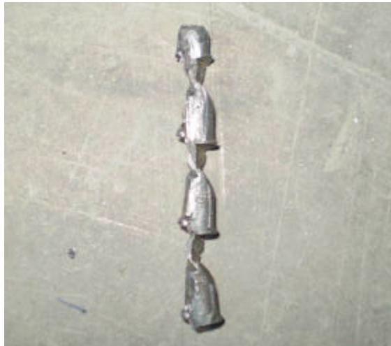
图 6.3 没有被轧断的轧件
