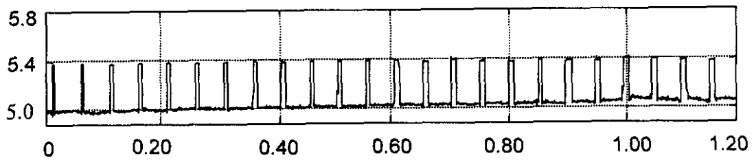
(b) 原始进给电流信号 ( i_{qs} ); 纵轴: A, 横轴: s
