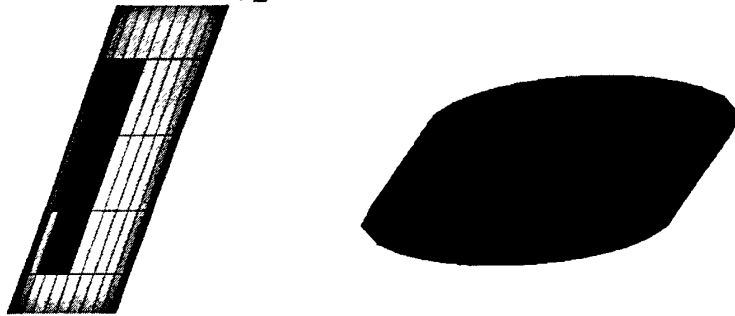
(a) \gamma_{xx} = 0.009 时 Z-pin 失效单元的分布 (b) \gamma_{xx} = 0.009 时树脂区失效单元的分布
