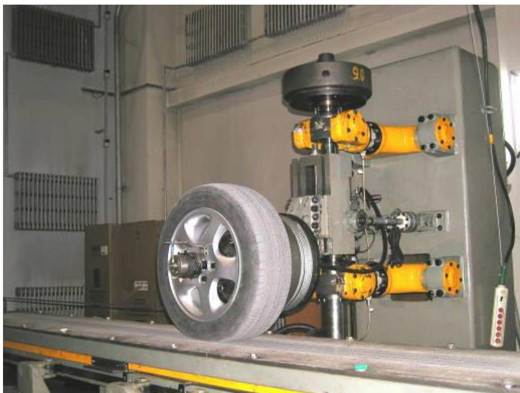
图 3-3 轮胎动特性试验台实物图
