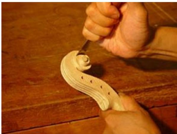
图 3-1 旋首两侧加工
