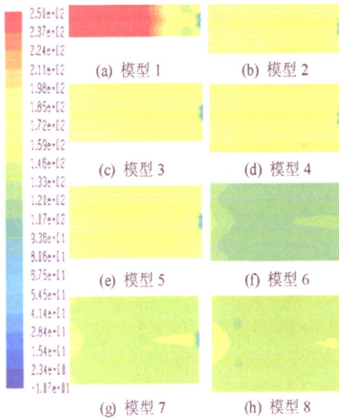
图 4.4 燃烧室 xoy 平面压力分布图
