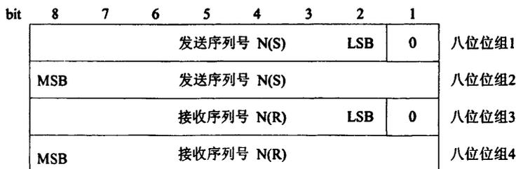
图 5-5 编号的信息传输格式（I 格式）的控制域
