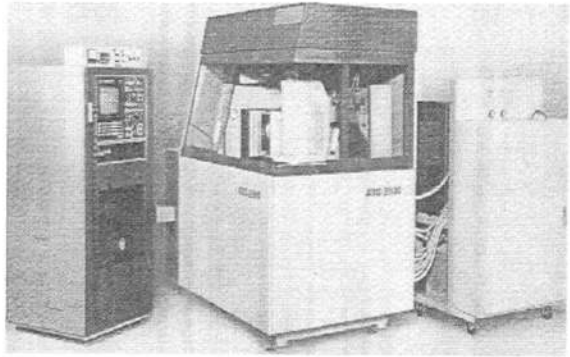
图 1.5 美国超精密数控车床 ASG-2500
