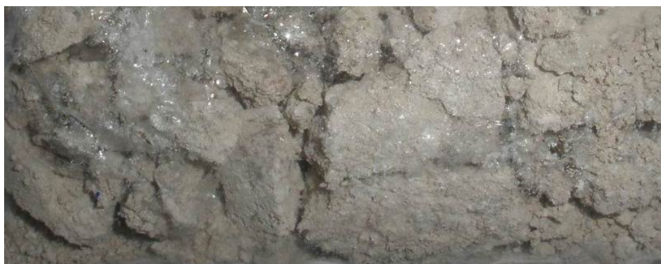
图 5.2 高温直接苛化水蒸气气化流化失败后从炉膛取出的固体产物实物照片
