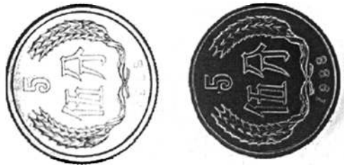
图 2-7 低角度照明 Fig.2-7 Low Angle Illumination
