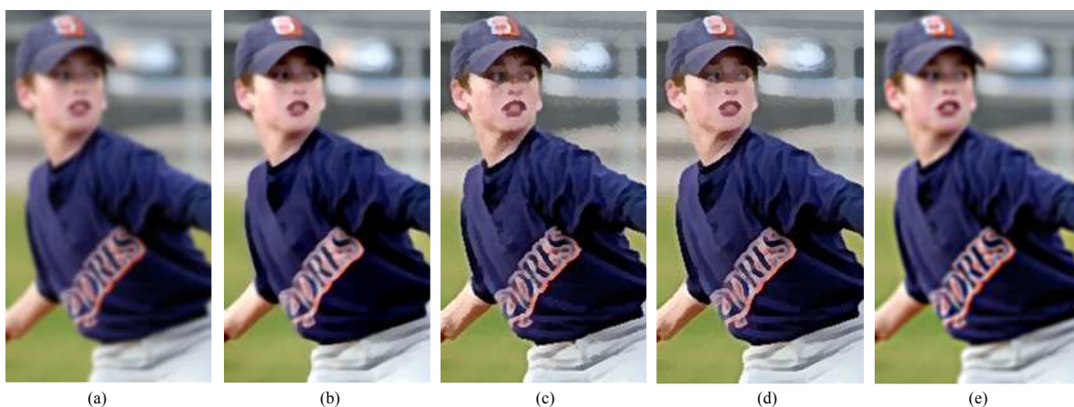
图 2-16 图像增强结果比较。(a) 输入模糊图像。(b) 我们的增强结果， \mu = 0.2 。(c) Osher-Rudin的shock滤波增强结果。(d) Kramer的shock滤波结果。(e) Unsharp masking的增强结果其中，高斯核宽度取2.0，添加高频信息的百分比率为100%。
