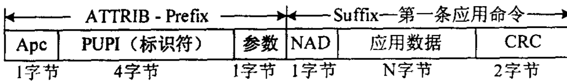
图4.10 如果IC卡的标识符与首标的标识符 (PICC) 相符, 那么通过用位于前面的ATTRIB - Prefix发应用命令可以选择一个IC卡
