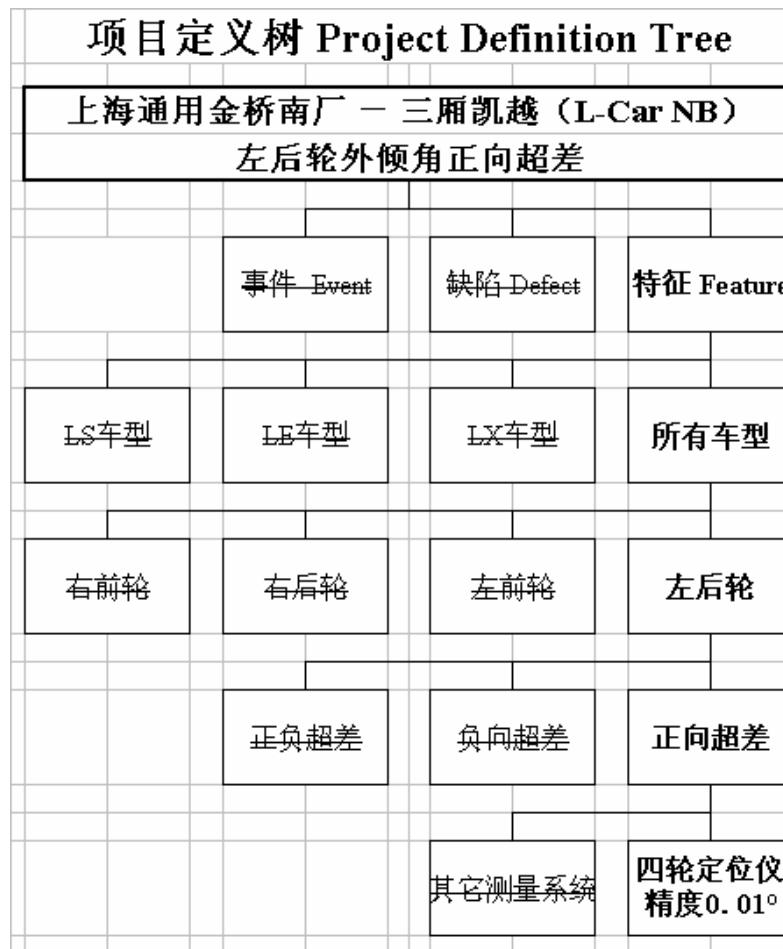
图 8 左后轮外倾超差的项目定义树
