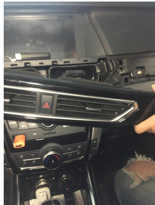
第三步：将空调出风口面板安装恢复
