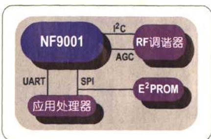
图9, NF9001典型应用。其中E 2 PROM可以去除,此时NF9001将从应用处理器(AP)中加载程序。
