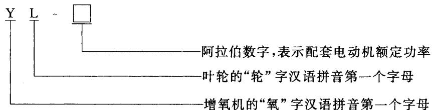
示例:YL-3.0 表示配套电动机额定功率为 3.0 kW 的叶轮增氧机。
