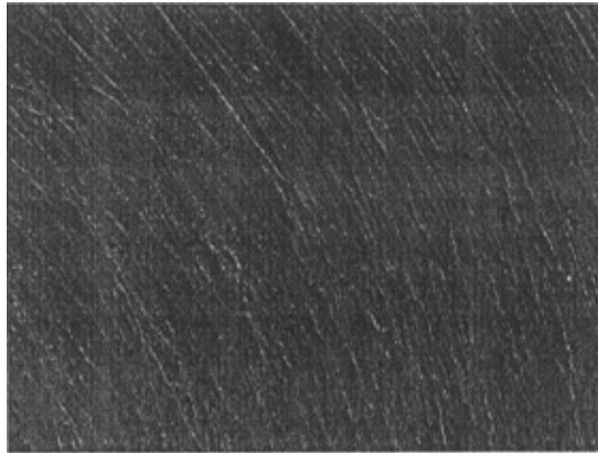
图 2.16 磨削轨迹 SEM 照片
