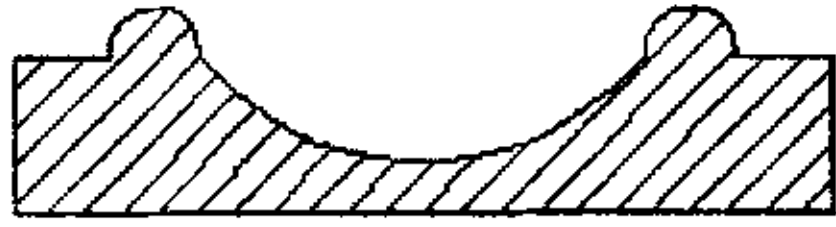
图 3-3 电火花放电凹坑断面几何形状
