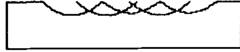
图 3-4 重叠的脉冲放电凹坑
