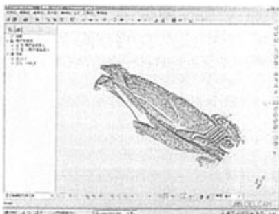
图 6-3 THUNDER RACER 赛车的扫描点云
