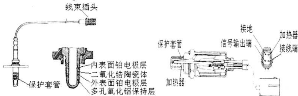
图 3-4 氧化锆氧传感器结构
