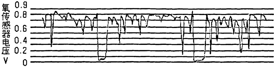
图 6-12c 喷油故障产生缺火
