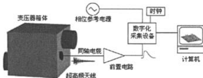
图 1.1 变压器局部放电超高频在线监测系统示意图
