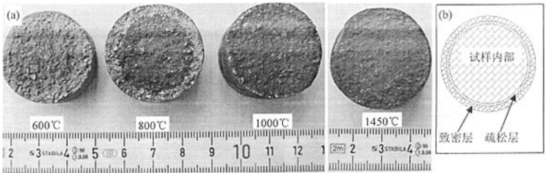
图 2.4 铝粉加入量为 10wt%的试样在不同温度处理后的断面照片(a) 及 1350℃或 1450℃处理后试样断面示意图(b)
